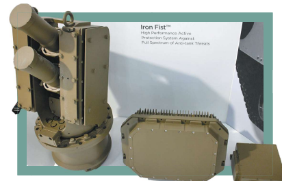
「鐵拳」利用小型感測器偵知周邊來襲威脅後，發射爆裂物製造衝擊波加以排除。 (取自埃比特網站)
