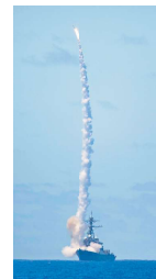
VLS 是目前唯一可配合如神盾等先進自動化、高速處理能力的系統。圖為美軍宙斯盾驅逐艦「班福德號」(DDG 65) 上的艦載垂直發射系統發射標準二型飛彈。
