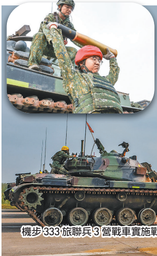
官兵合力將105公厘破甲榴彈搬運至砲塔內部，完成射擊前整備。(記者張詠翔攝)
